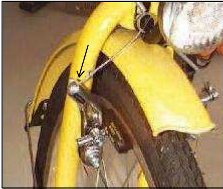
Zug an Cantilever-Bremse aushängen...
