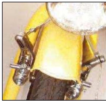
Abschließend Bremse und die Freigängigkeit des Vorderrads überprüfen ...
