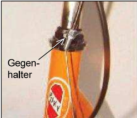
Nun Bremszug auch aus dem Gegehalter aushängen ...
